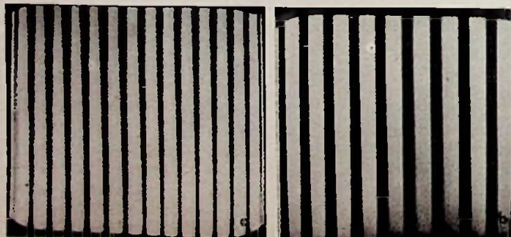
Bild 34. Balkenraster zur Prüfung der Linearität der Zeitablenkung; a = Sinusspannung von einigen Volt an das Gitter 1 der Bildröhre gelegt. b = Durch Anlegen einer größeren Sinusspannung an den Meßspannungseingang erhält man scharf begrenzte Balken, da infolge Übersteuerung der Verstärkerstufe mit der Röhre EF 80<sup>1</sup> eine Rechteckspannung entsteht
